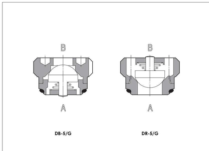
DB, DR - обратные клапаны прямого действия для резьбового монтажа, размера от G1/4" до G1/2".
